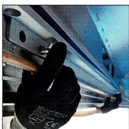
EASY REMOVAL OF UPPER SEALING BAR / EINFACHES ENTFERNEN DER OBEREN SIEGELLEISTE
