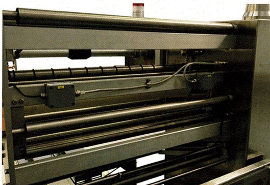
Servo-driven reel mounting system with brake Sistema portabobina servo-azionato con freno motorizzato
